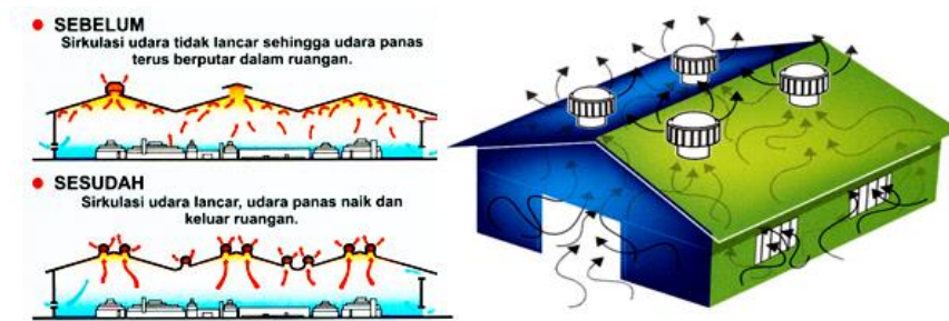
Gambar 3. 8 Sistem kerja turbin ventilator Sumber : (2.bp.blogspot.com, 2022)
