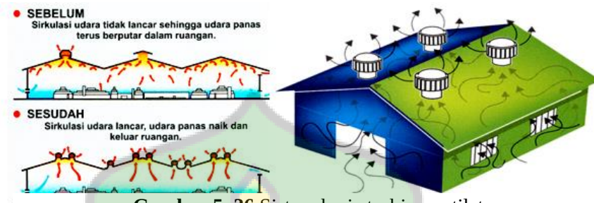
Gambar 5. 36 Sistem kerja turbin ventilator Sumber : (2.bp.blogspot.com, 2022)
