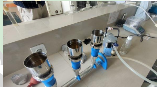
Gambar 3.4 Proses penyaringan TSS menggunakan Vacum
