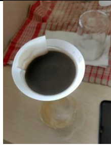
Gambar 1.10 pencucian POFA menggunakan aquades
