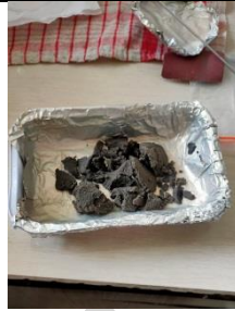
Gambar 1.11 POFA yang akan dikeringkan dengan oven
