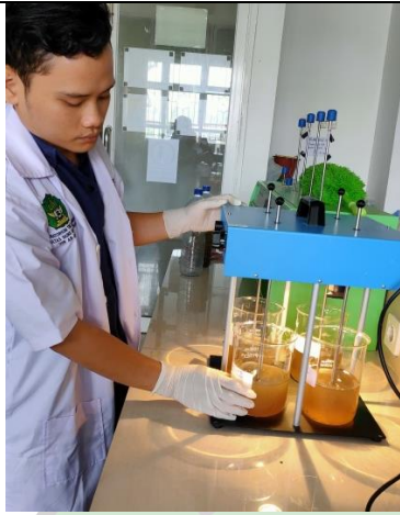
Gambar 3.1 Pengadukan menggunakan jar test
