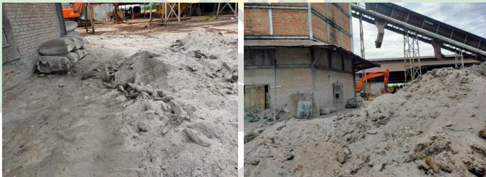
Gambar 2.2 Abu hasil pembakaran tandan kosong di dalam insinerator
