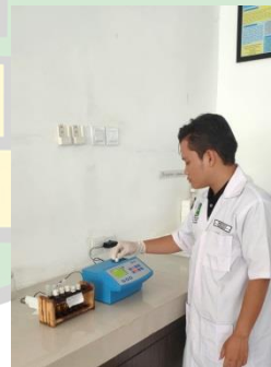
Gambar 3.6 Proses pengecekan Nilai COD
