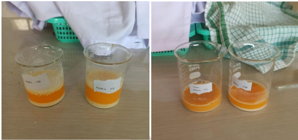
Gambar 4.6 Proses adsorpsi Methyl orange dengan serbuk cangkang telur
