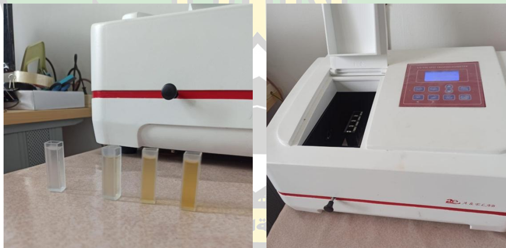
Gambar 4.9 Uji menggunakan instrumen UV-Vis
