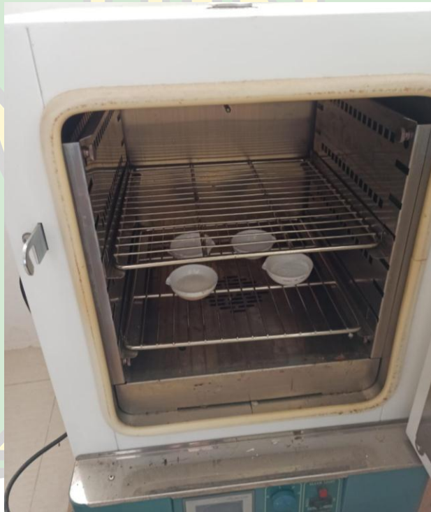
Gambar 4.5 Serbuk cangkang telur dikeringkan dengan oven
