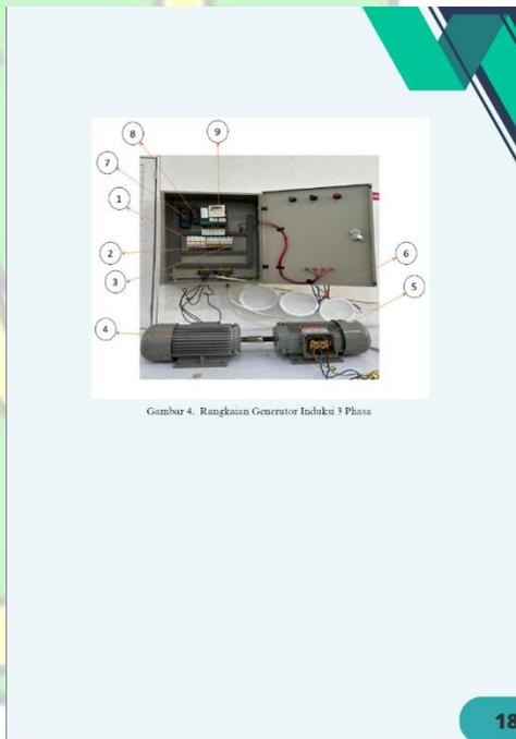
Gambar 4.9 Tampilan Prosedur Perakitan Rangkaian Generator Induksi 3 Fasa
