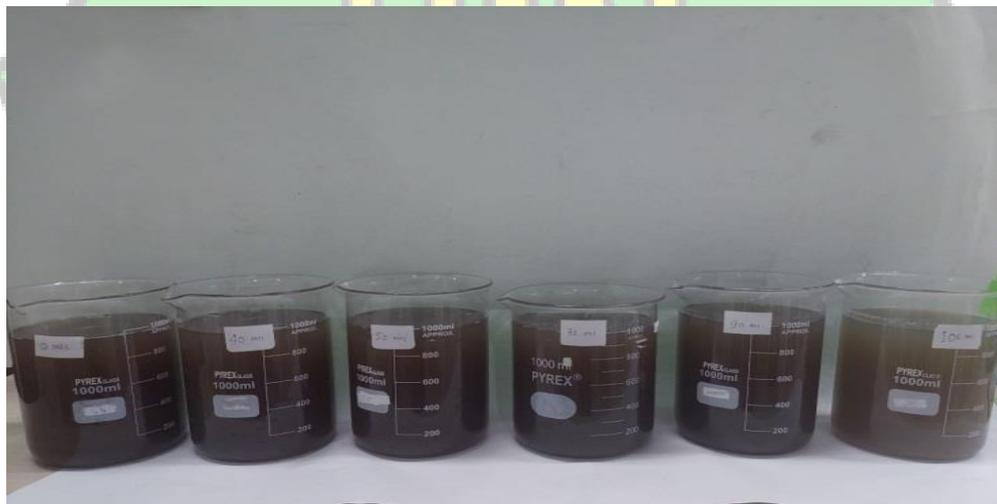
**Gambar 4.3** Proses Pengendapan Air Limbah Pasar Ikan setelah Perlakuan dengan Biokoagulan Cangkang Kerang Lokan (*Geloina erosa*)
