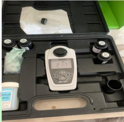
**Gambar 3.6** Turbidimeter
