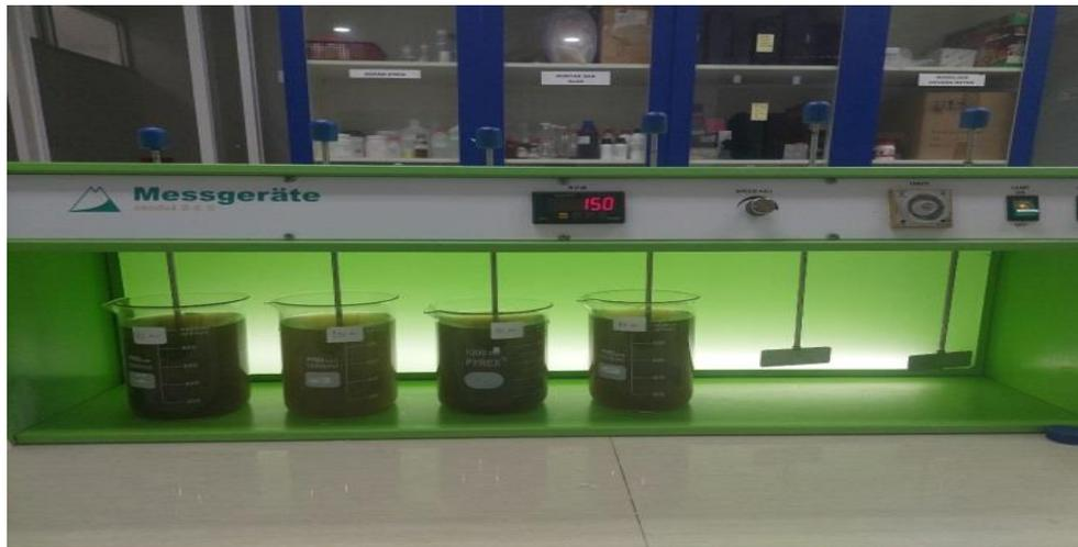
**Gambar 4.2** Proses Pengadukan Kecepatan 150 rpm dengan Biokoagulan Cangkang Kerang Lokan (*Geloina erosa*)
