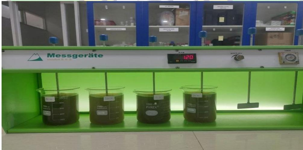
**Gambar 4.1** Proses Pengadukan Kecepatan 120 rpm dengan Biokoagulan Cangkang Kerang Lokan (*Geloina erosa*)
