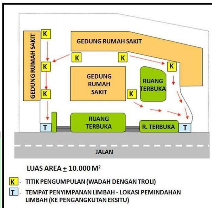
Gambar 2.10 Contoh Tata Letak Sistem Pengumpulan Limbah dari Fasilitas Pelayanan Kesehatan
