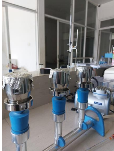
Pengujian TSS sampel setelah uji koagulasi/flokulasi
