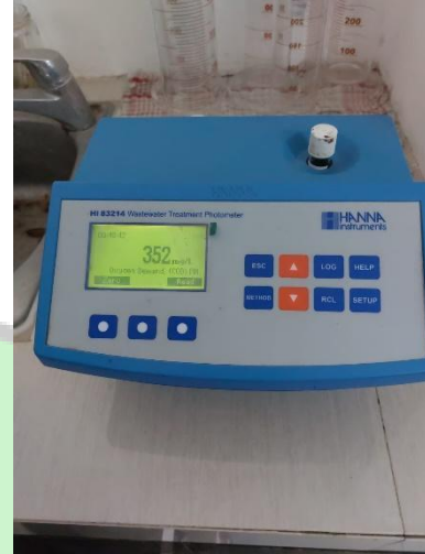
Pengujian COD sampel setelah uji koagulasi/flokulasi
