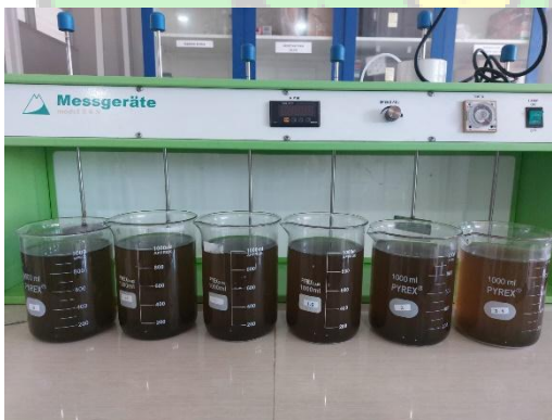
Sampel setelah ditambahkan variasi dosis flokulasi
