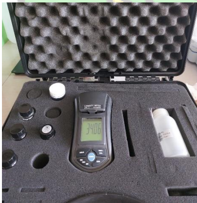
Pengukuran Turbiditas setelah uji Koagulasi/flokulasi
