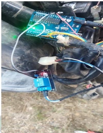
Gambar 4.4 Proses Pemasangan Relay Pada Kelistrikan Motor
