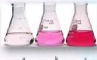
Gambar. 6. (a) Belum mencapai titik ekuivalen, (b) sudah mencapai titik ekuivalen, (c) terlalu jauh untuk menentukan titik ekuivalen
