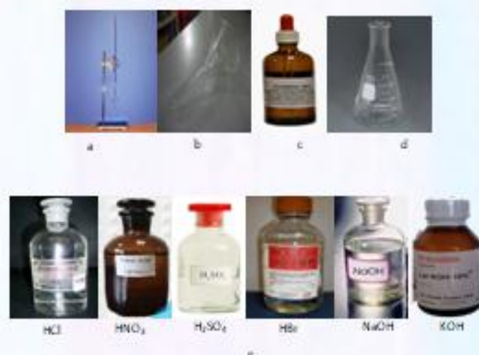
Gambar 1. (a) buret, (b) corong, (c) indikator fenolftelin (pp), (d) erlenmeyer, (e) larutan analit atau larutan standar pada titasi asam basa
