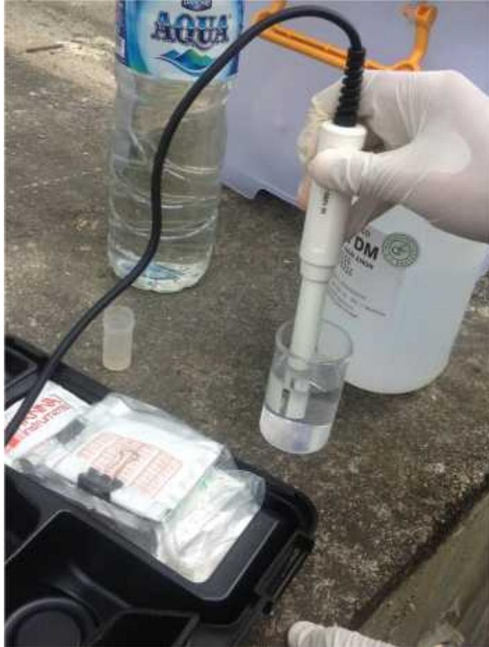
Gambar 3. Proses Pengukuran pH sampel Air asrama Rusunawa menggunakan alat Multiparameter
