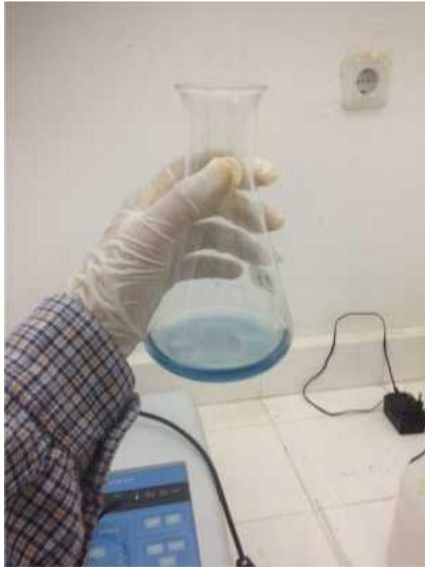
Gambar 11. Perubahan warna setelah proses titran
