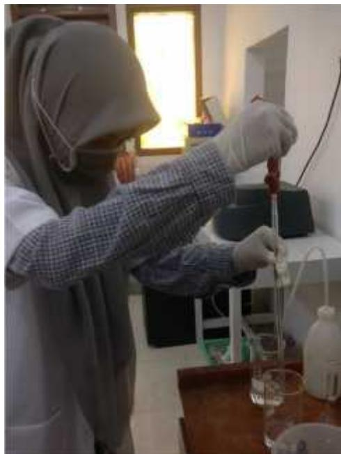
Gambar 6. Proses Penambahan Larutan HCL pada sampel untuk pengujian Nitrat
