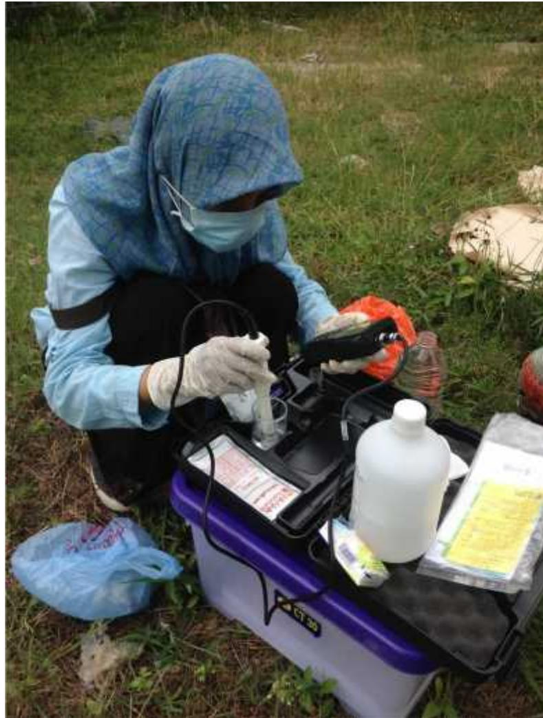
Gambar 4. Proses Pengukuran Sampel Air Asrama SCTV menggunakan alat Multiparameter
