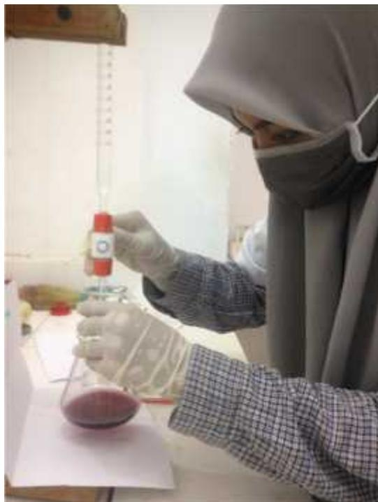
Gambar 10. Proses Titrasi setelah penambahan Etilen EBT
