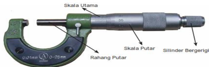
Gambar 2.4. Bagian-Bagian Mikrometer Sekrup
