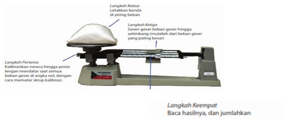
Gambar 2.6. Pengukuran Massa Benda Dengan Neraca O'hauss
