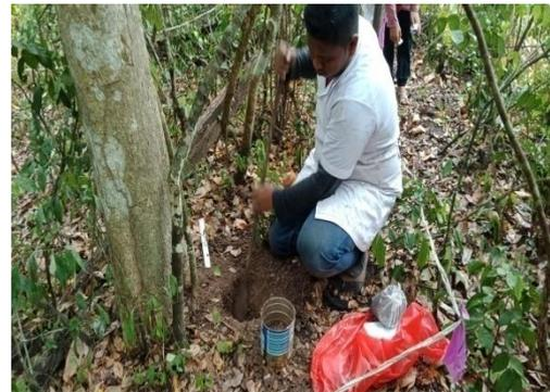
Gambar 4. Pengambilan Sampel Tanah
