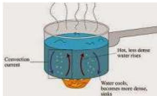
Gambar 2. 4 Perpindahan kalor secara konveksi
