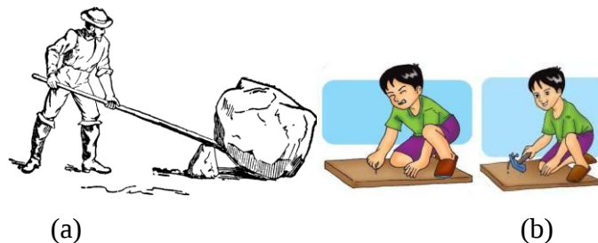
Gambar 1. (a) Kerja dengan bantuan tuas (b) perbedaan menggunakan bantuan tuas dan tidak menggunakannya
