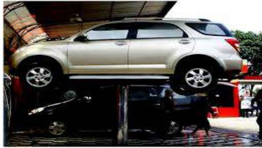
Gambar 2.11 Mesin hidrolik pengangkat mobil
