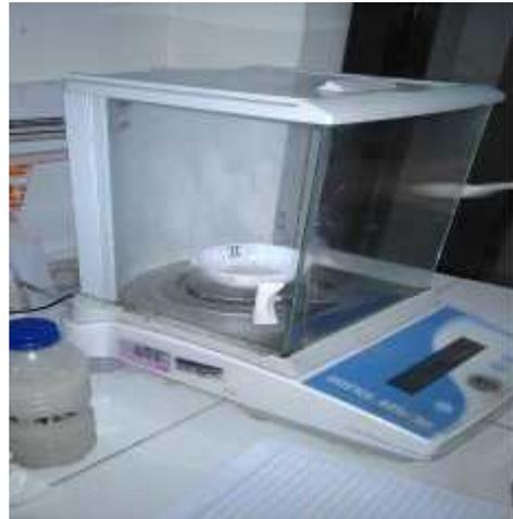
Gambar.6 Penimbangan susu untuk uji lemak
