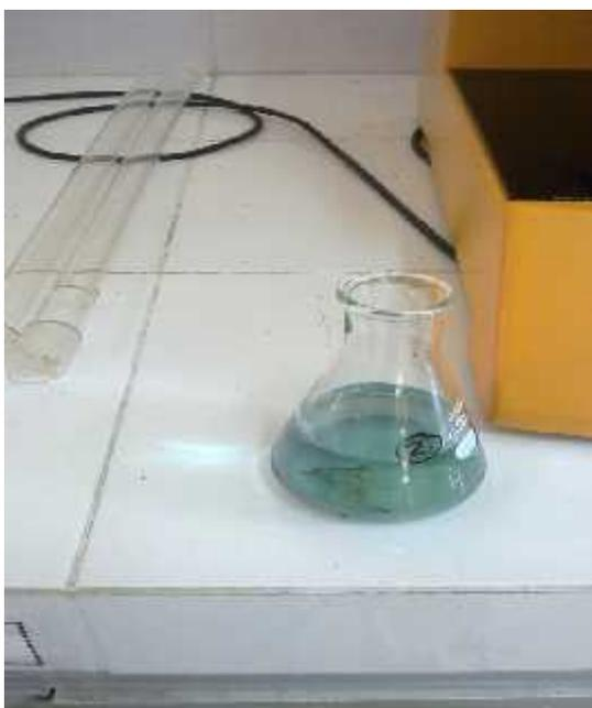
Gambar 4.6 Sampel Susu Biji Durian Setelah Dipanaskan dengan Campuran Selen.<sup>44</sup>
