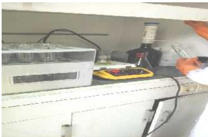
Gambar 3.2 Penambahan H<sub>2</sub>SO<sub>4</sub> Dalam Sampel.<sup>37</sup>
