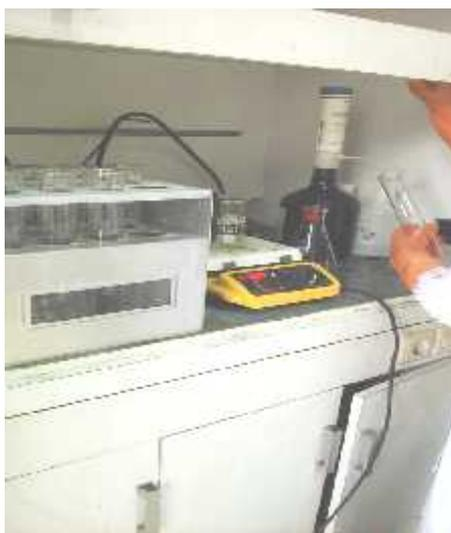
Gambar.11 Penambahan  $H_2SO_4$  dalam sampel (protein).
