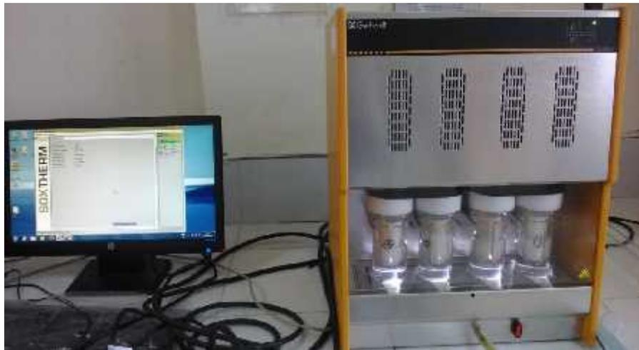
Gambar 3.4 Sampel yang Dimasukkan ke dalam Soxhlet.<sup>39</sup>
