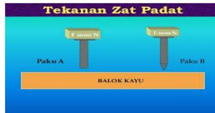
Gambar 2.1 Tekanan pada zat padat
