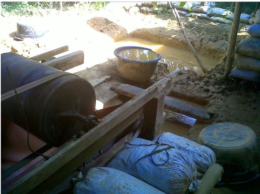
Gambar 7: Mesin Penggiling “glendong” batu atau tanah biji emas.
