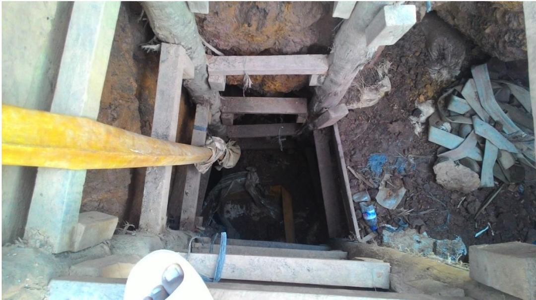
Gambar 4: Lubang galian emas yang berkedalaman lebih dari 15 meter, dengan menggunakan *blower* untuk bantuan oksigen di dalam lubang yang berada di Desa Simpang Dua.
