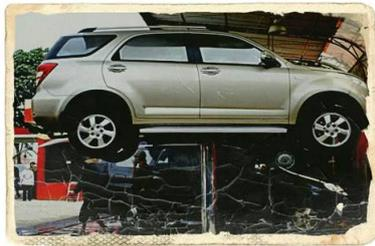
Alat pengangkat mobil bisa dijumpai di berbagai tempat seperti di bengkel mobil atau tempat cuci mobil. Alat pengangkat mobil ini memiliki prinsip kerja berupa prinsip Pascal. Namun media yang digunakan bukanlah air atau cairan melainkan udara.
